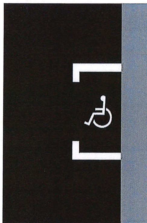
V 10f VYHRAZENÉ PARKOVIŠTĚ PRO VOZIDLO PŘEPRAVUJÍCÍ OSOBU TĚLESNĚ POSTIŽENOU
